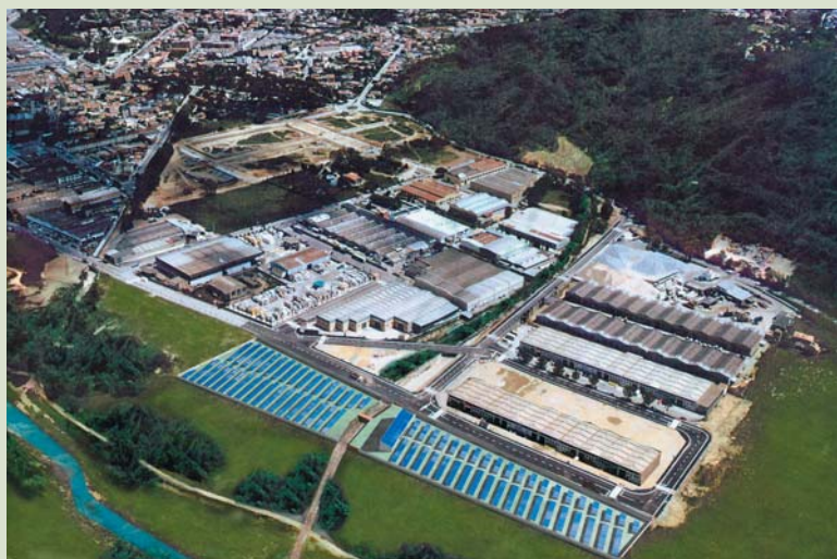
Le parc photovoltaïque est constitué de 8 ensembles d'une puissance unitaire moyenne de 95,6 kWc reliés à plusieurs onduleurs de 1,5-2,5 kW.
