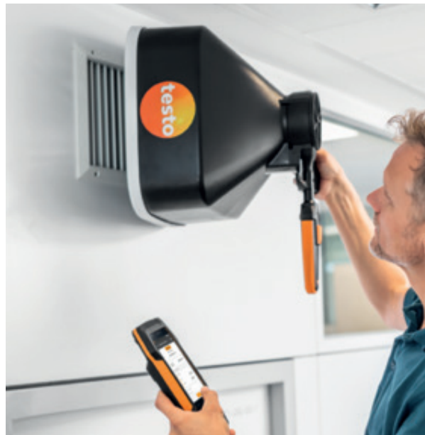
► Mesure intelligente de la vitesse et qualité de l'air avec le testo 400.
