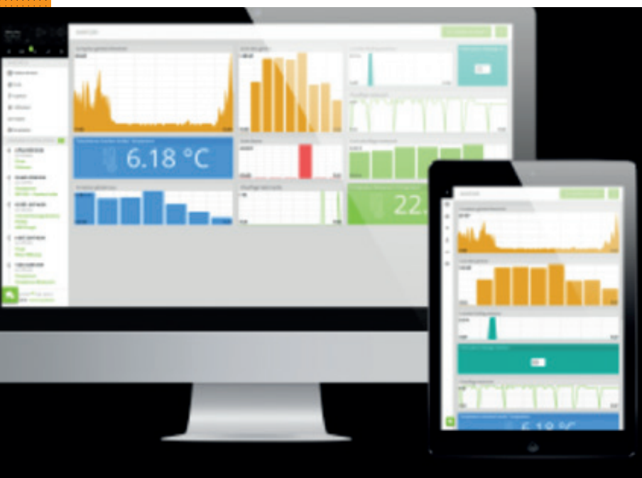
► Exemple de suivi des consommations d'énergie.
