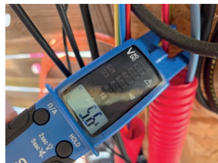
▲ La pince ampèremétrique à l'extrémité permet de mesurer des courants alternatifs jusqu'à 200 A.
